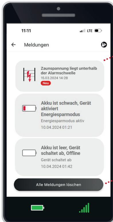
Der Smart Satellite meldet die Unterschreitung der gewählten Mindesthüftenspannung, sowie den schwachen Batteriestand oder die leere Batterie!
